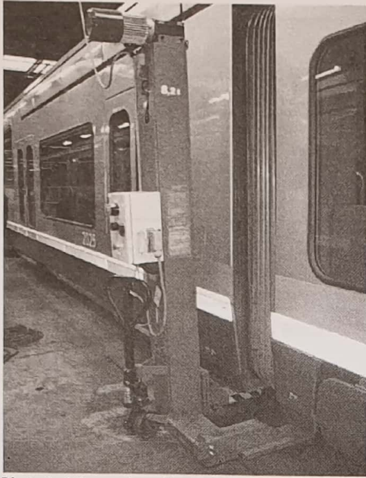
Photo 3 : Mise en place d'une colonne
