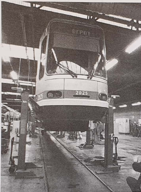
Photo 5 : Tramway en position soulevée
